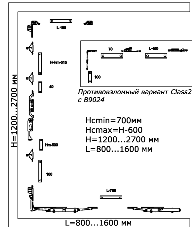
8.9.10. Створка массой до 200 кг с фурнитурой 02913 . Ручка с механизмом 02951 и механизмом под установку цилиндра 02952.
